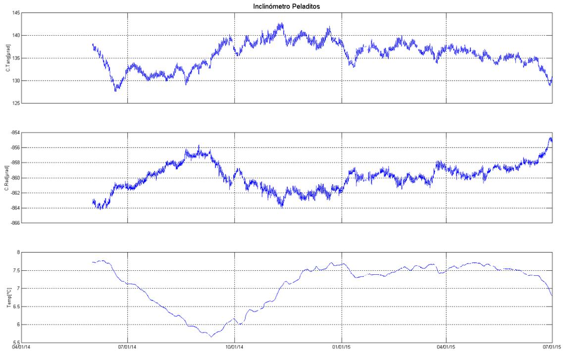
**Figura 17.** Componentes de inclinación Radial y Tangencial ( $\mu\text{rad}$ ), temperatura del inclinómetro electrónico Peladitos, instalado en Galeras, para el periodo comprendido entre el 1 de junio de 2014 y el 30 de junio de 2015.
